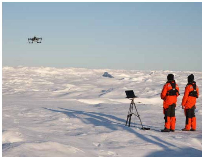
Julian Rothe und Michael Strohmeier testen auf einer Eisscholle den mit zwei GPS-Systemen ausgestatteten Multikopter. (Foto: Jonas Hagemann)
